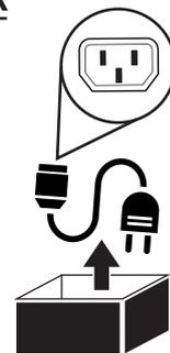
BRANCHEZ LE CÂBLE D'ALIMENTATION AU BOÎTIER 1 ET VÉRIFIEZ QUE L'INTERRUPTEUR EST SUR ON 2
